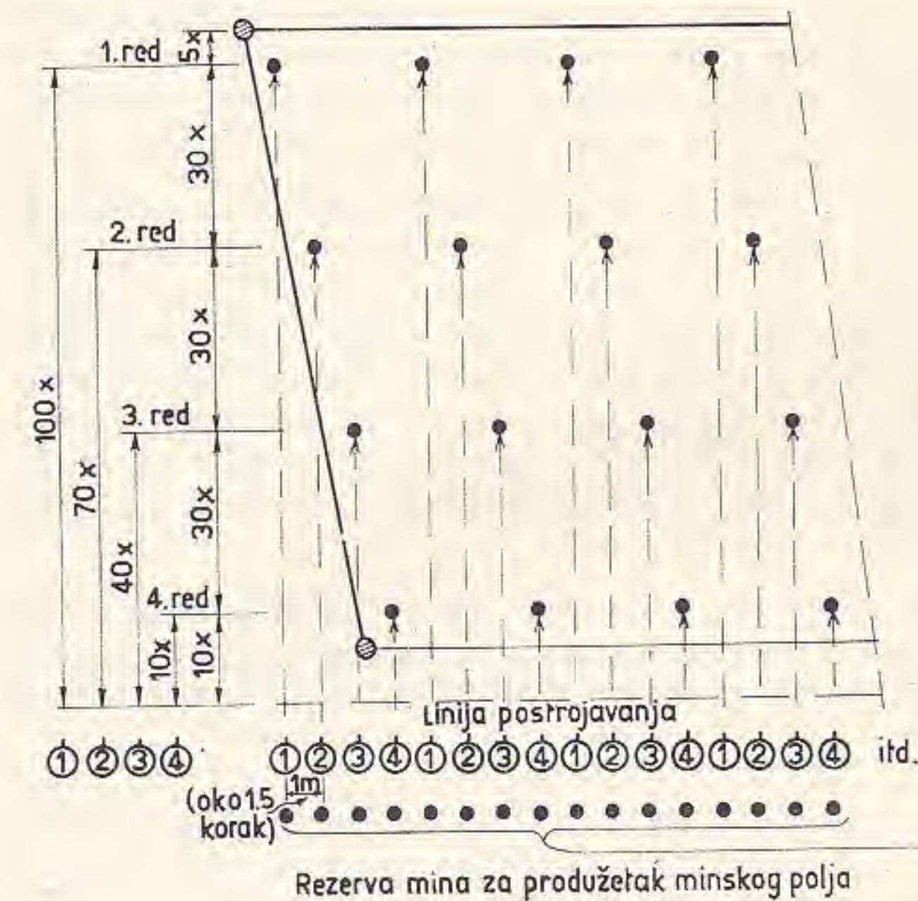
Sl. 17 — Način raspoređivanja protivtenkovskih mina strogim rasporedom — treći način
